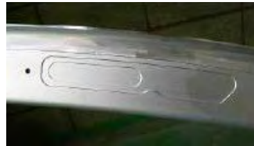
想定される加工面 (ケミカルミリングの加工面)
