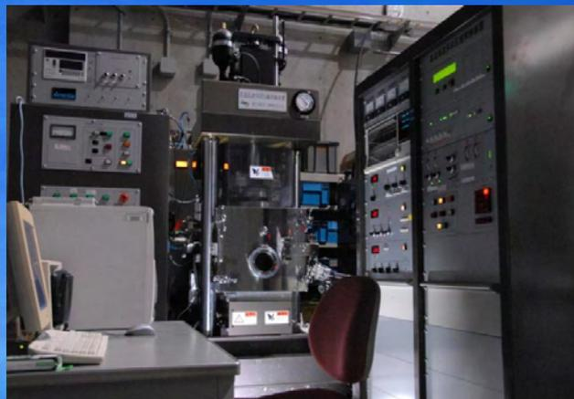
温度・ひずみ速度制御材料試験機
