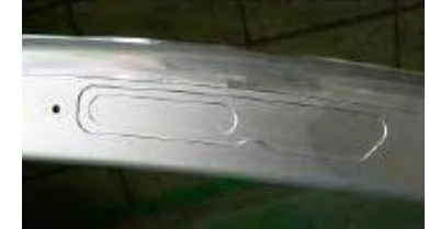
想定される加工面 (ケミカルミリングの加工面)
