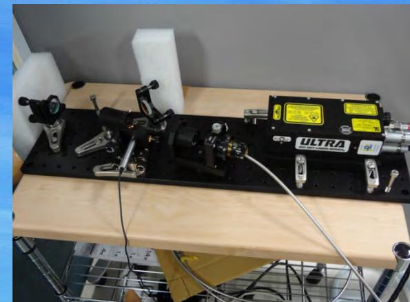
非破壊検査試験装置
