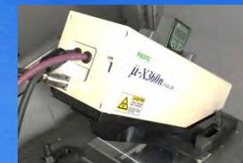
X線残留応力測定装置
