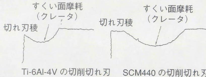
**Fig15** チタン合金 Ti-6 Al-4 V と合金鋼 SCM 440 を切削したときに発生するクレータ摩耗特性の比較
