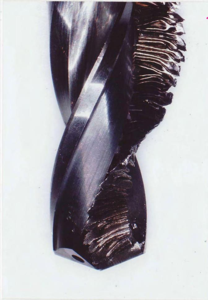
Fig3 チタン合金のドリル切削における切りくず詰まり現象<sup>7)</sup>
