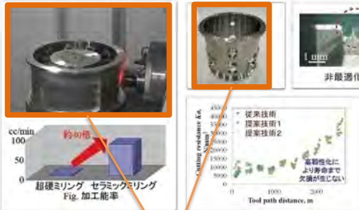
サイアロン系セラミック工具高靱性化による高能率切削
