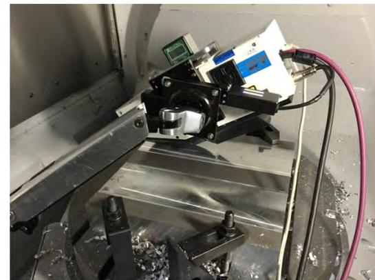
ポータブル型X線残留応力測定装置
