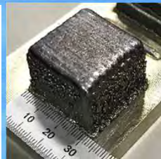
最適積層条件で造形した耐熱合金
