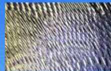
側壁部に発生したびびりの例
