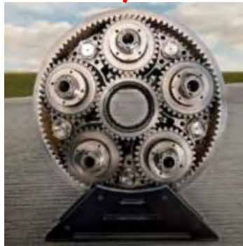
Fan Drive Gear System
