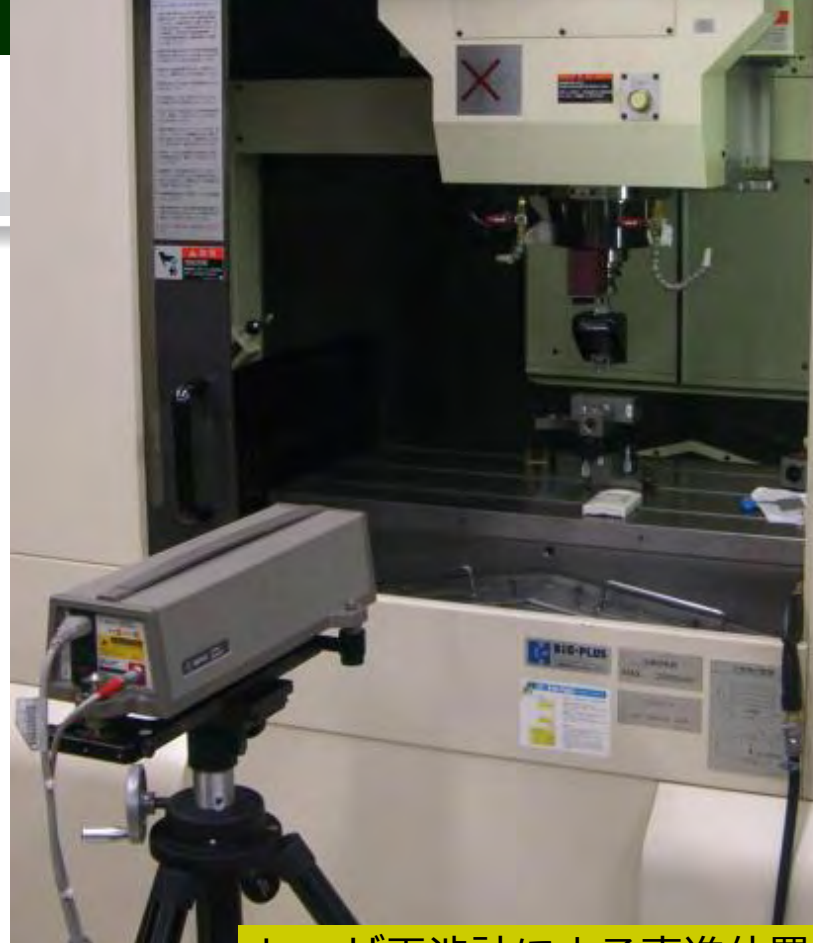
レーザ干渉計による直進位置 決め偏差の測定
