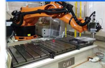
金属加工による性能評価 Performance evaluation by metal milling
