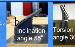
傾斜角と捩れ角を持つ積層体 Fabrication with inclination and torsion angles
