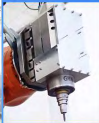
加工用 モータユニット Milling head
