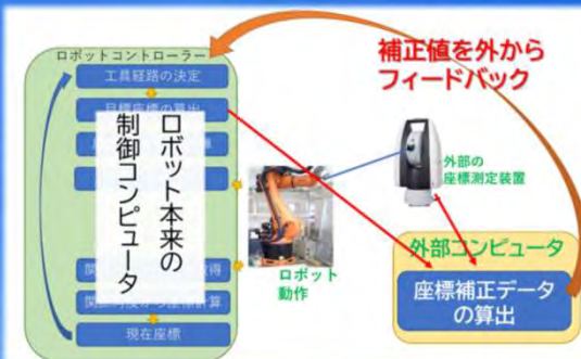
オンライン補正システムの概略 Outline of online correction system
