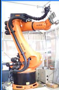
6軸多関節ロボット 6-axis articulated robot
