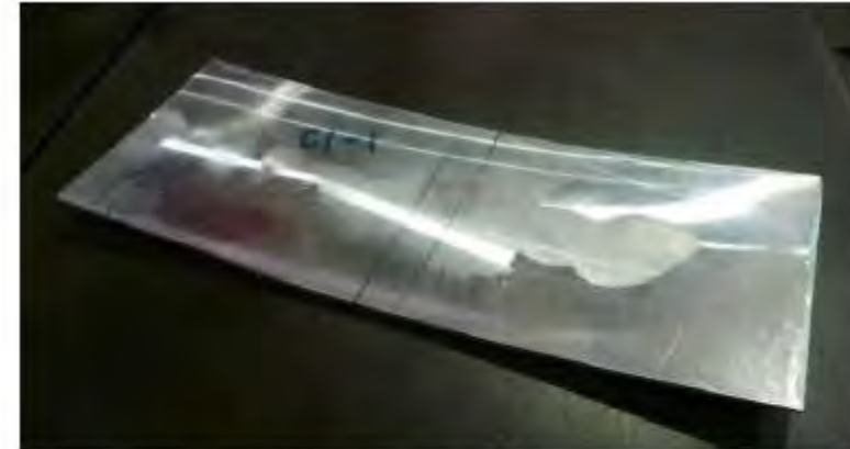
正面フライス加工後に変形したAl-Li板 (両側の把持部は加工後に切断)
