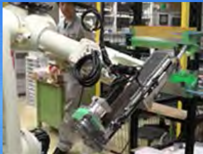
ロボットシーリング
