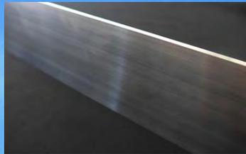
実部品を想定したモデル形状加工において、開発した工具と加工法を適用した結果、びびりやミスマッチのない高品位かつ高能率な加工が可能であることを実証。
